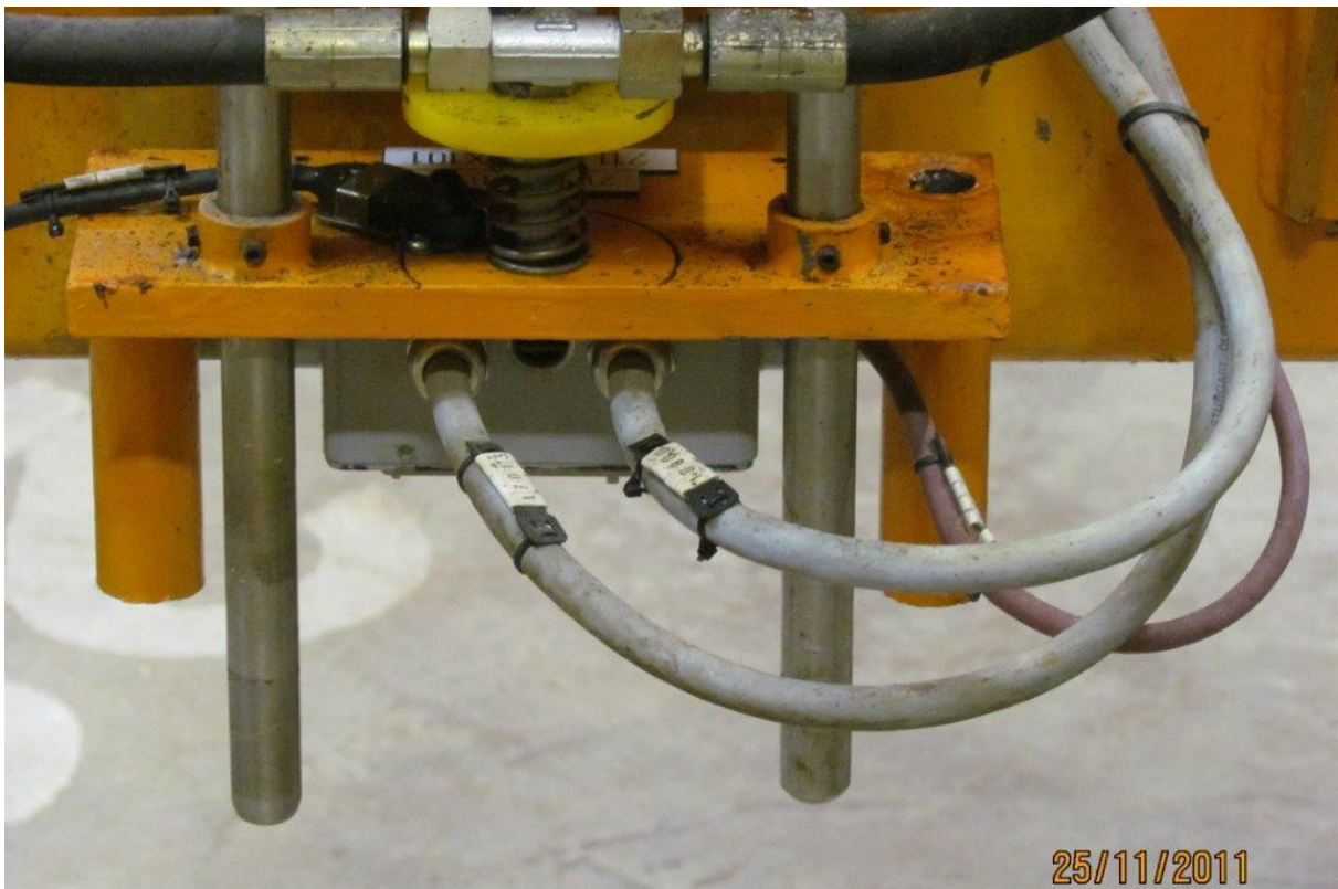
Foto som visar kontaktdosan för el – och kontroll till lyftdonet från sidan.
