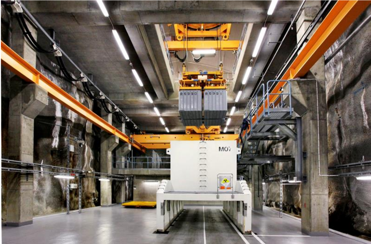
Lyft av fyra stålkokiller från ATB 12K för deponering i Silo. I detta läge är kokillerna separerade på det sätt de stått i ATB.
